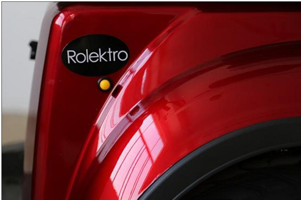
**Schalter für Freilauf funktioniert nur bei eingeschalteter Zündung.**
