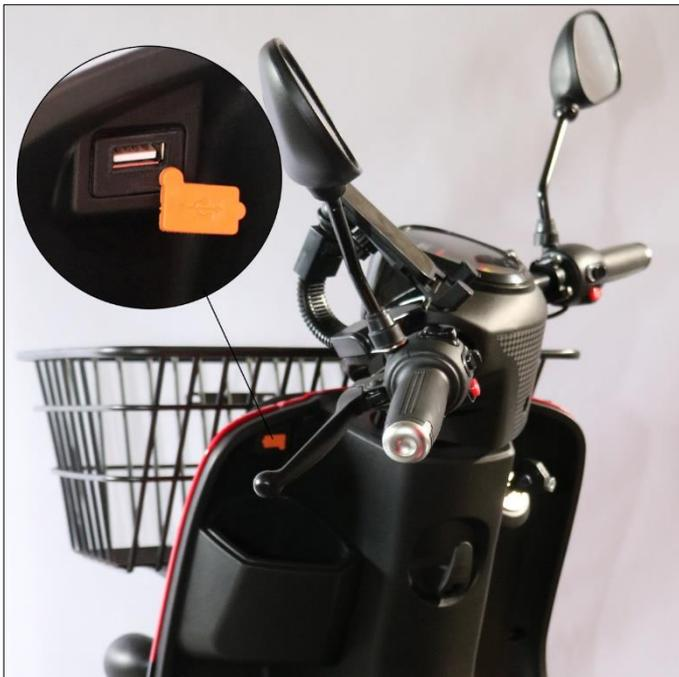
Die USB-Ladebuchse befindet sich unterhalb eines orangenen Spritzwasserschutzes, den Sie zur Seite drehen müssen.
